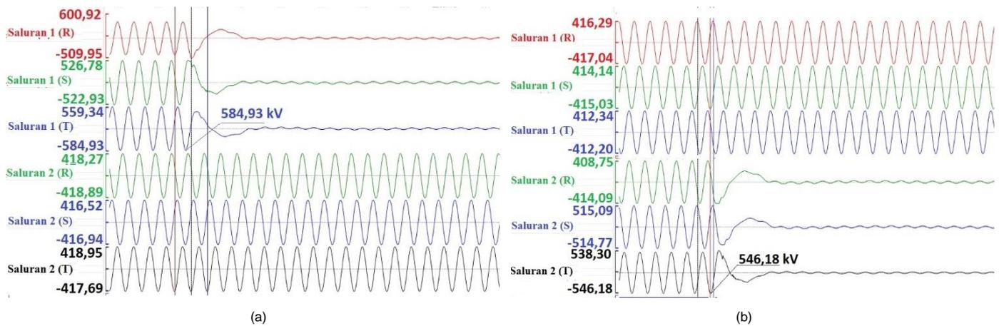
Gambar 3. Rekaman DFR, (a) saluran 1 dalam kondisi belum terinjeksi tegangan, (b) saluran 2 dalam kondisi belum terinjeksi tegangan.
