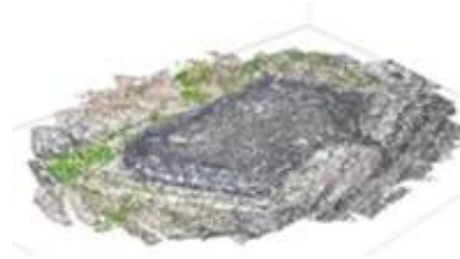
Gambar 6. Hasil Point Cloud Proses Align Photos.
