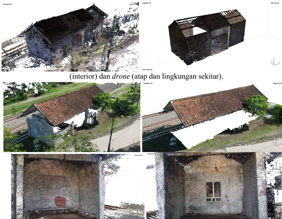
Gambar 8. Interior bangunan hasil pemrosesan foto 360. Noise dapat dilihat sebagai bercak hitam yang berada disekeliling model.
