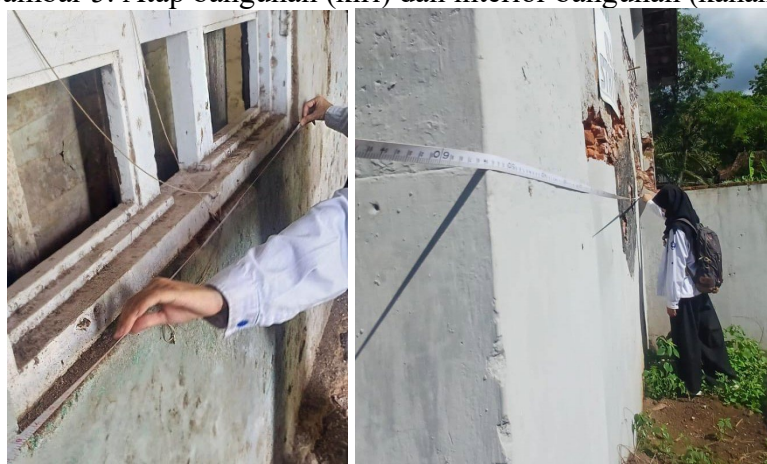
Gambar 6. Pengukuran check scale bar dilakukan pada fitur-fitur menonjol dan mudah diidentifikasi pada foto dan model.
