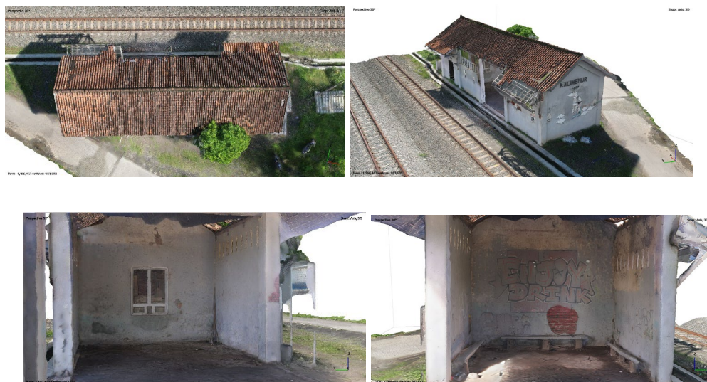
Gambar 10. Hasil penggabungan model menjadi sebuah mesh BCB Stasiun Kalimenur (dari kiri ke kanan dan atas ke bawah) view bagian atas, eksterior, interior menghadap timur dan interior menghadap barat.
