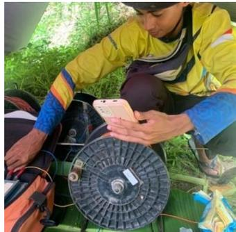
**Gambar 3.** Proses pengukuran resistivitas tanah menggunakan alat geolistrik
