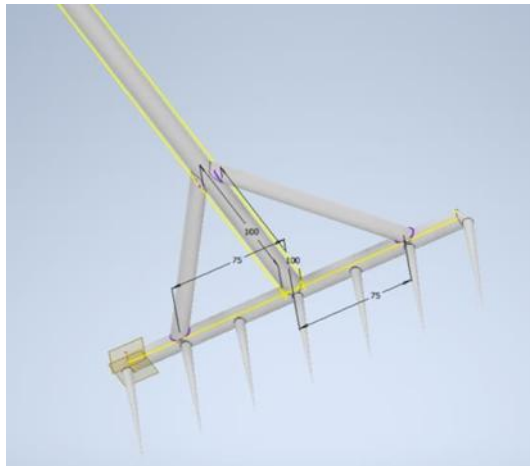
Gambar 7. Desain alat pemanen eceng gondok
